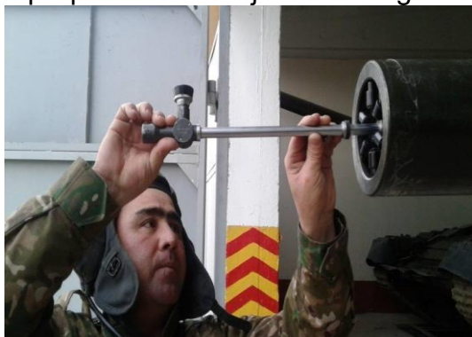
3-rasm. Tank pushkasi stvol kanali o'qini pritsel nol mo'ljallash chizig'i bilan rostlash moslamasining qo'llanilishi.
